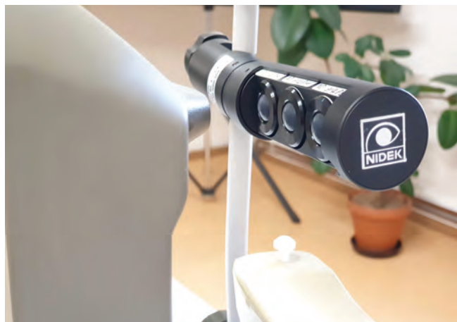
Obr. 4: Ověřování bezkontaktního tonometru pomocí sady umělých očí (Nidek)
