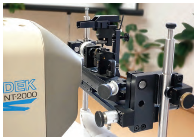
Obr. 5: Ověřování bezkontaktního tonometru pomocí zkušebního zařízení flapper (Feinmechanik Teltow GmbH)
