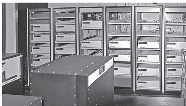
Obr. 4: Část velkého souboru atomových hodin provozovaných v USNO (U.S. Naval Observatory). Ve stojanech jsou umístěny komerčně vyráběné cesiové hodiny 5071A. V popředí komerčně vyráběné aktivní vodíkové masery.
