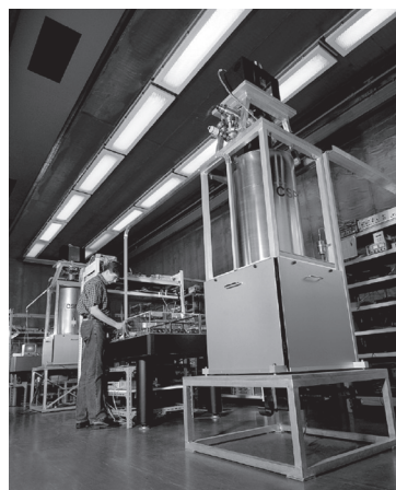
Obr. 6: Cesiové fontány PTB-CSF1 a PTB-CSF2 provozované v PTB Braunschweig. Obě cesiové fontány jsou využívány k navázání času TAI na sekundu SI.
