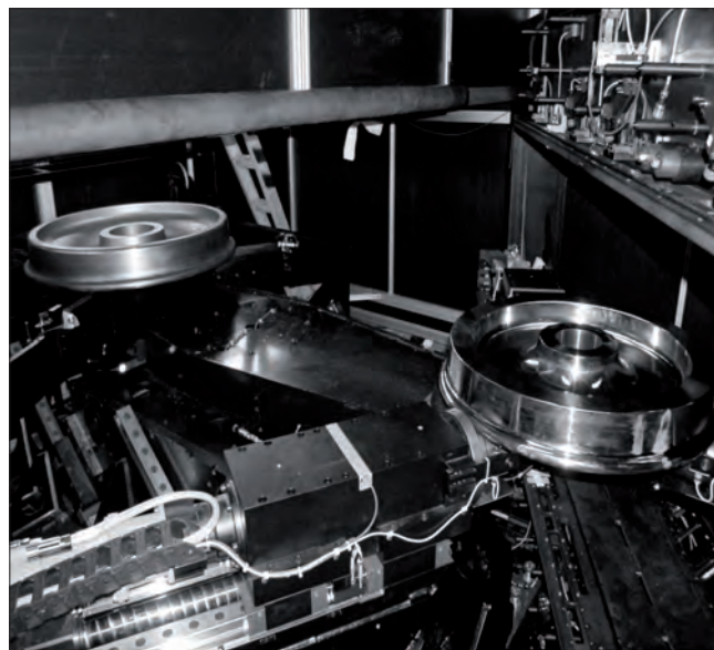
Obr. 4: Automatická měřicí stanice KS-528 (AMEST)
