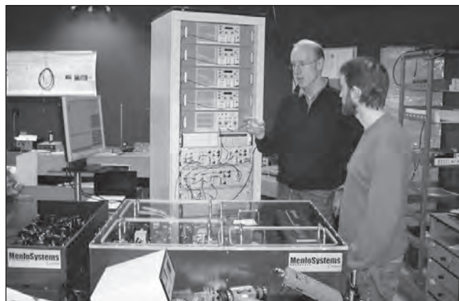
Obr. 5: Generátor fs hřebene Menlo Systems FC 8004 s řídicí a vyhodnocovací elektronikou instalovaný v ČMI LPM
